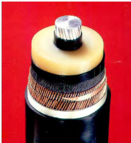
Figur 30. Tvärsnitt på en enledarkabel i enlighet med de som föreslås ingå i respektive kabelförband för planerade 130 kV kraftledningar.
